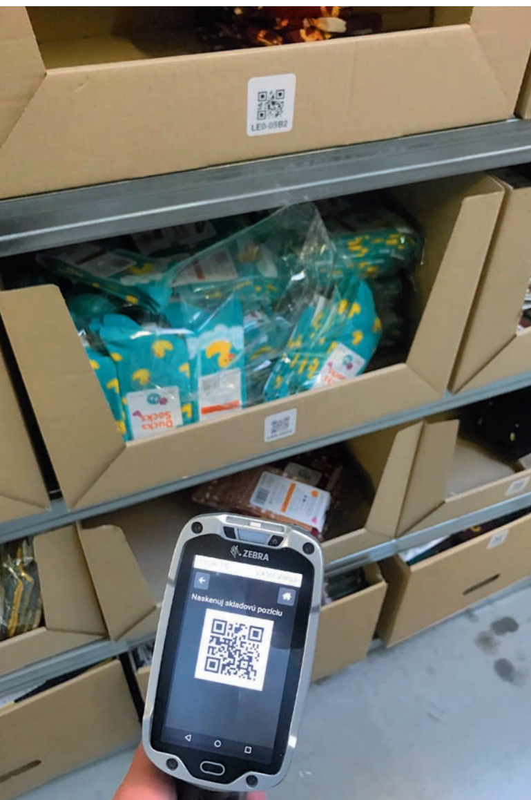
Systém EMANS pripravuje zoznamy pre niekoľkých operátorov súčasne, ktorých aj riadi a naviguje v sklade prostredníctvom ručného skenovacieho zariadenia v reálnom čase.
