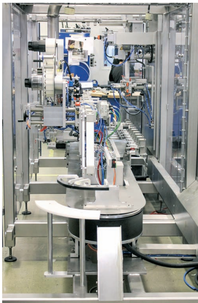
Spoločnosť Wolf vyvinula uzatvárací stroj špeciálne s ohľadom na vyšší výkonový rozsah s oddeleným transportným riešením SuperTrak založeným na lineárnom pohone s rovným dlhým statorom spoločnosti B&R.
