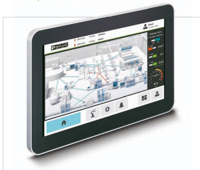
Obr. 1 V závislosti od aplikácie možno škálovať priemyselné počítače s veľkosťou displeja od 15,6 do 21,5", ktoré poskytujú rozlíšenie Full HD.
