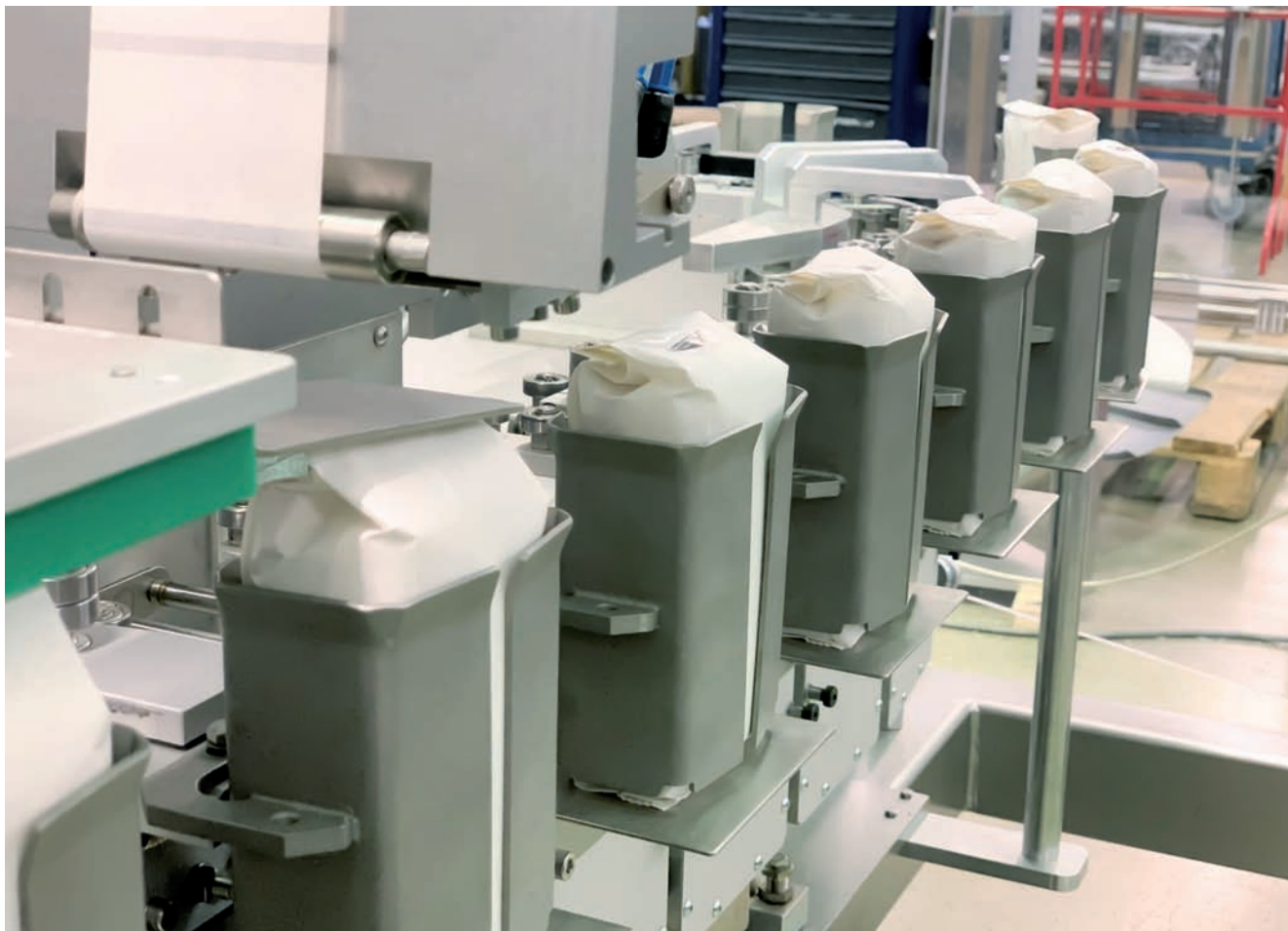
Pri systéme SuperTrak treba pohnúť iba s vozíkmi a držiakmi vreciek, čo je podstatne menšia hmotnosť ako pri trvalo pripojenom dopravníku – to znamená, že na zrýchlenie a brzdenie treba menej energie.
