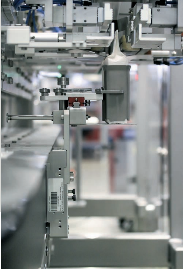
Transportný systém stroja s horným uzatváraním premiestňuje každé vrecko do spracovateľských staníc individuálne.
