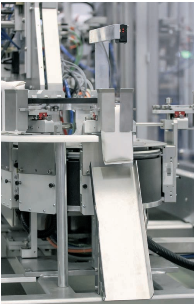
Vďaka voľne programovateľným pohybovým profilom SuperTraku majú vývojári viac slobody v usporiadaní spracovateľských staníc a podľa potreby môžu stanice vynechávať alebo pridávať.
